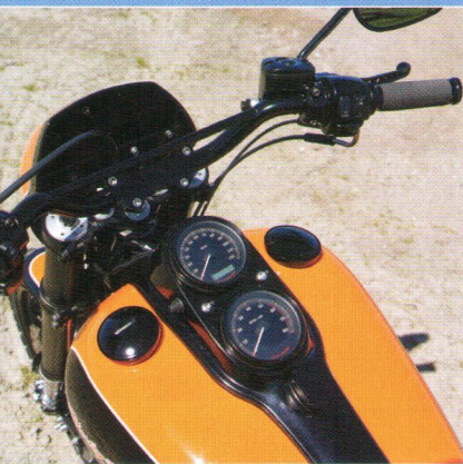
pijpje tussen het originele stuur om er een cross te maken.
